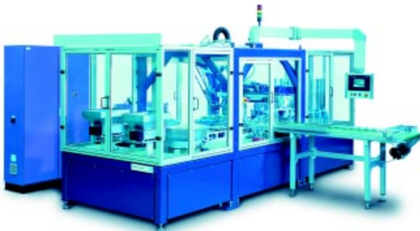
Automat fremstillet til Hydro Aluminium Hycot A/S i Løgumkloster. Den fremstiller lamelkølere til køling af hydraulikolien i bilers servosystemer (Foto: ProInvent A/S).
